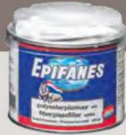
En hurtigtørkende to-komponent sparkel egnet for små reparasjoner på stål og glassfiber. Kan påføres i tykke lag. Før bruk tilsett 2-4% av reaktoren fra tuben i basen og bland godt sammen. Overmalbar med alle Epifanes en-og to-komponent produkter.
