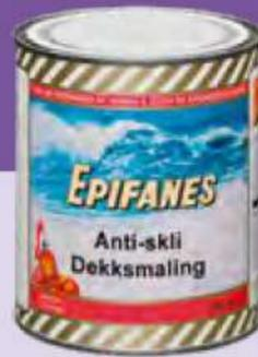
En en-komponent, halvblank, uretan/alkyd basert antiskli dekkmaling som inneholder tilmålt mengde polypropylen perler som antiskli middel. For å unngå inntak av fuktighet, påføres Epifanes Antiskli Dekkmaling etter minst to strøk høyglans. Påføring med korthåret rulle gir en jevn fordeling av perlene. Rør godt om før og under bruk. Tillat siste strøk å tørke minst 72 timer for å herde grundig.
